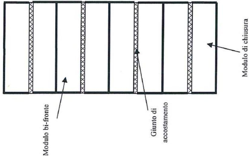
**Armadio compattabile mono-fronte.** È costituito da scaffali a singolo accesso accostati. La figura seguente schematizza la tipologia indicata:
