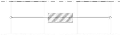
**Scenario S1:** caratterizzato dall'incendio di un autoveicolo commerciale in corrispondenza della mezzeria della trave o del solaio.
