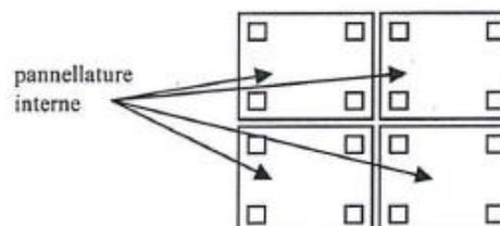
□ Termocoppie per la sorveglianza dei giunti interni a vista (concorrono sia alla verifica della temperatura massima che alla verifica della temperatura media della zona di appartenenza). Sono poste a 20 mm dai bordi.
