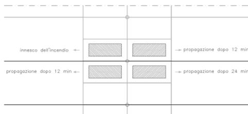
**Scenario S3:** caratterizzato dall'incendio di 4 veicoli posti intorno ad una colonna. L'incendio si avvia da uno di essi, dopo 12 minuti si propaga a 2 veicoli, dopo ulteriori 12 minuti si propaga all'ultimo veicolo; uno dei veicoli deve essere un autoveicolo commerciale.
