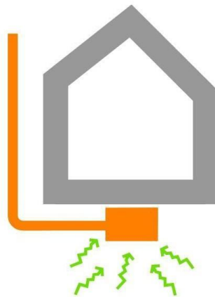
Figura 16: depressione del sottosuolo tramite pozzetto.
