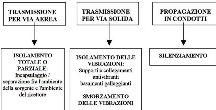
**Figura 6.5:** Tecniche di controllo della trasmissione sonora.
