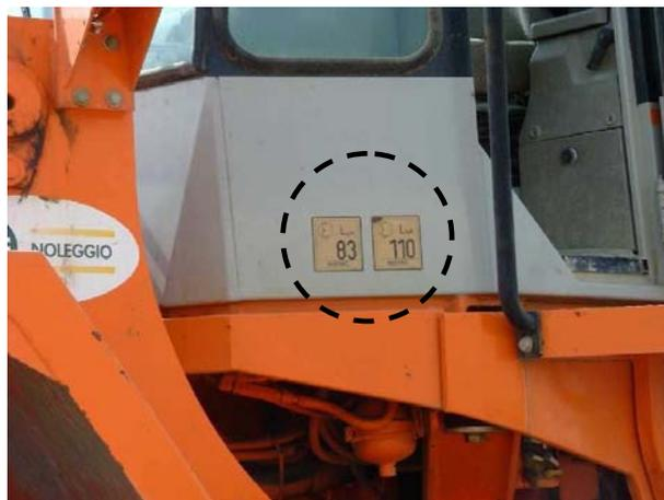
**Figura 5.2:** Targhette di informazione del livello di pressione sonora al posto di lavoro  $L_{pA}$  (sinistra) e di potenza sonora  $L_{wA}$  (destra) previste dalla normativa vigente fino al 31/12/02 per alcune macchine funzionanti all'aperto
