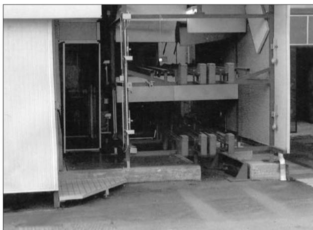
**Figura 10. Banco di entrata dell'accatastatore per lo scarico delle bombole da collaudare**
