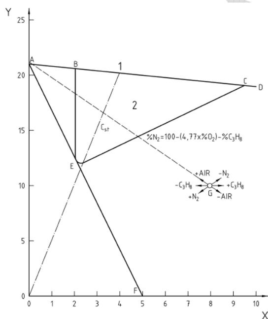
Figura 2 - Diagramma di esplodibilità di una miscela propano-ossigeno-azoto [CEN/TR 15281]
