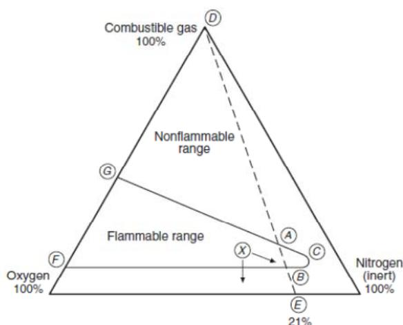
Figura 3 - Diagramma triangolare di esplosibilità relativo ad una generica miscela combustibile-ossigeno-azoto [NFPA 69]
