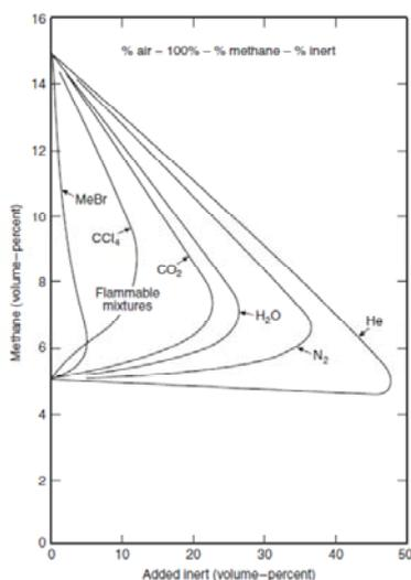
Figura 1 - Influenza dell'aggiunta di gas inerti, vapor d'acqua e inibitori sui limiti di esplodibilità di miscele metano-aria [NFFA 69]
