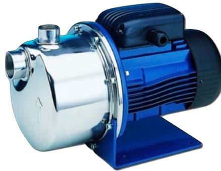
Da Wikipedia: "La pompa autoadescante è una tipologia di pompa idraulica centrifuga con installazione sopra battente (in aspirazione). Pertanto, come tutte tali tipologie di macchine, aspira da un livello più alto del liquido da pompare e quindi necessita di un adeguato adescamento per poter funzionare correttamente".
