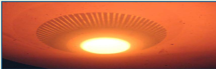
Visuale interna di uno scambiatore di calore metallico a fascio tubiero utilizzato nella produzione del vetro
