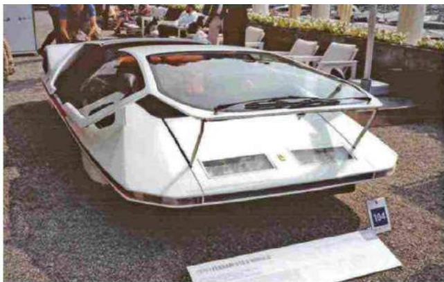
Il tettuccio-parabrezza scorrevole non è assistito da alcun servocomando, richiedendo braccia robuste per le operazioni di apertura/chiusura dell'abitacolo.
