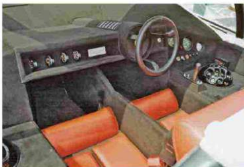
L'interno è semplice e dal disegno essenziale. I due strumenti all'estrema destra sono stati aggiunti recentemente, così come alcune leve sottostanti. La semisfera è stata ricavata da una vera palla da bowling.
