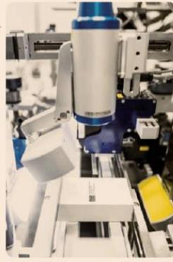
Esempio di un sistema di visione SEA Vision per la tracciabilità dei farmaci
