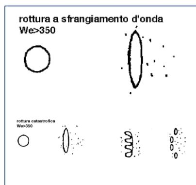
A numeri di Weber più alti, si formano sulla superficie della goccia delle onde molto piccole, le cui creste vengono continuamente erose dall'azione aerodinamica. Quando le onde di maggior ampiezza e lunghezza penetrano nella goccia, si verifica il fenomeno della "rottura catastrofica" che porta a un processo multistadio in cui i primi frammenti sono soggetti a ulteriore rottura.
