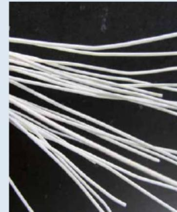
Nella foto membrane a fibra cava per la purificazione dell'acqua ottenute in R&D Membrane Lab - Solvay Campus - Bollate.
